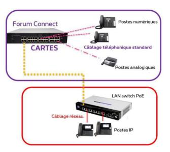
La grande différence est le câblage nécessaire à l'installation. Les appareils numériques et analogiques sont raccordés au central téléphonique avec du câblage téléphonique standard. Leur raccordement se fait à travers de cartes qui sont insérées dans le système. Ils sont alimentés par le central téléphonique.
